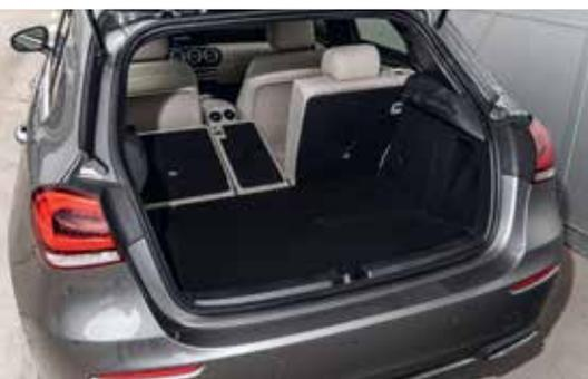
Leichteres Einräumen, weniger zerklüfteter Boden: 67,2 mm misst die Ladekante
