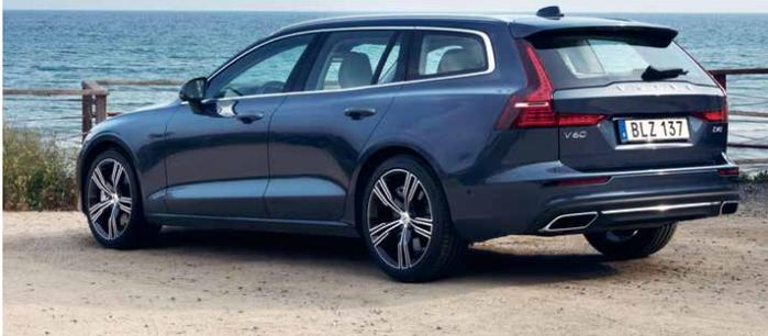
Konturierter Rücken, breite und weit aufschwingende Klappe, niedrige Ladekante
