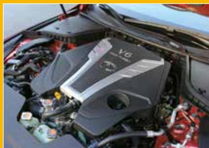
Top-Aggregat ist ein hauseigener, neu bearbeiteter V6-Biturbo mit 405 PS und 475 Nm
